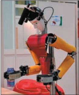
Dynamaid nimmt Befehle entgegen, greift und übergibt Objekte – auf Wunsch auch eine Dose Bier.
