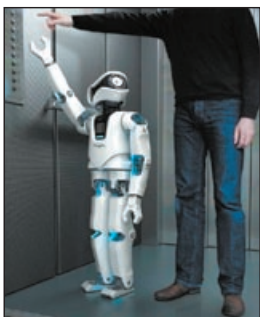
Abnehmbare Arme: Sind Myons Gliedmaßen zu kurz, können sie im laufenden Betrieb ausgetauscht werden. Quelle: HU Berlin
